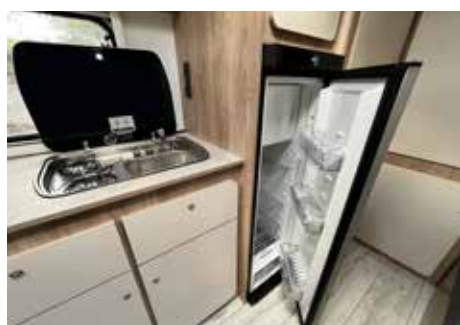
Vestavěná trojkombinační chladnička s mrazákem (12V/230V/plyn).
