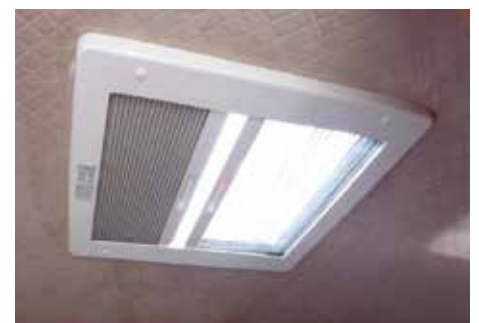
Střešní okno s ventilací, sítkou a zatemněním.
